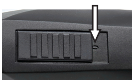
Slika 4 Klizni prekidač u položaju ISKLJUČENO („0“)
