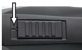
Fig. 5 Interrupteur position marche (« I »)
