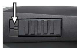
Fig. 6 Interrupteur position marche (« II »)
